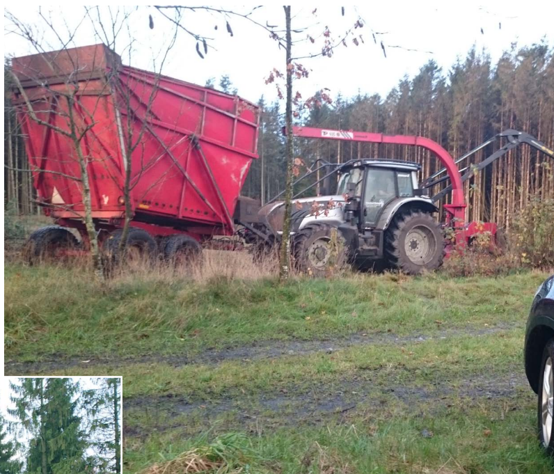
Foto øverst. Traktormonteret TP hugger i færd med at hugge topende i en afdrift af rødgran. Denne type kan hugge flis i tyndinger og på afdrifter. Maks diameter på topenderne er 40 cm, men oftest vil middeldiameteren være omkring 12-14 cm.
