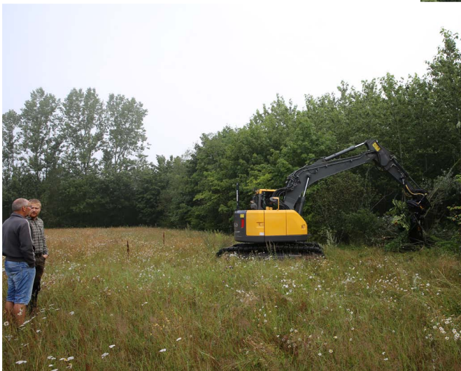
En gravemaskine påmonteret et klippeaggregat er velegnet til tyndinger og oprydning af meget busket træ.
